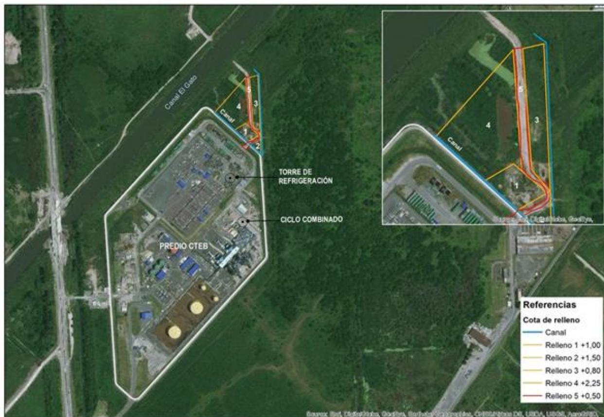
**Figura 3. Zona de relleno con material sobrante de las excavaciones. Las referencias indican aproximadamente la diferencia entre la cota actual del terreno y la cota de diseño final de +3,50 m**
